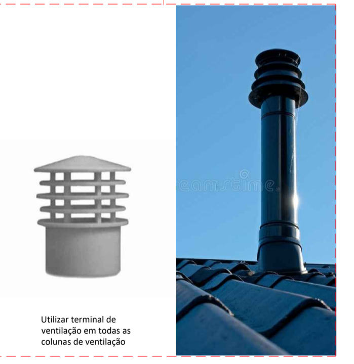
DETALHE 01 TERMINAL DE VENTILAÇÃO
